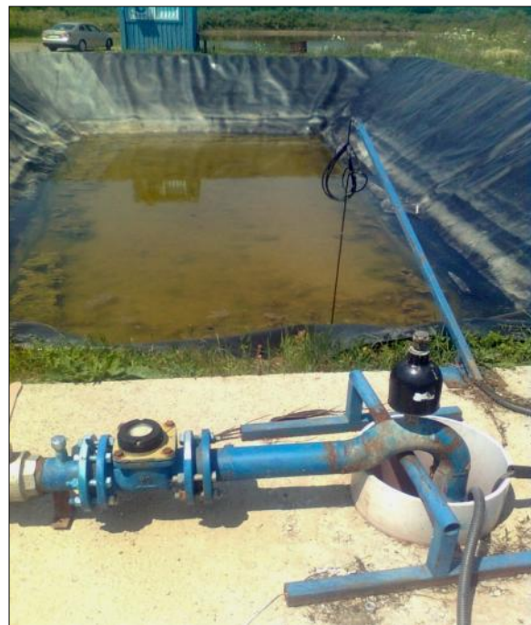
Talajvíz-tisztítás a kunmadarasi reptéren
