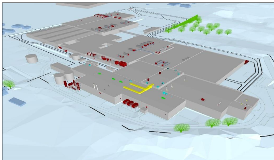
Zajmodell felépítése az IMMI zajtérképező szoftverben (háromdimenziós)
